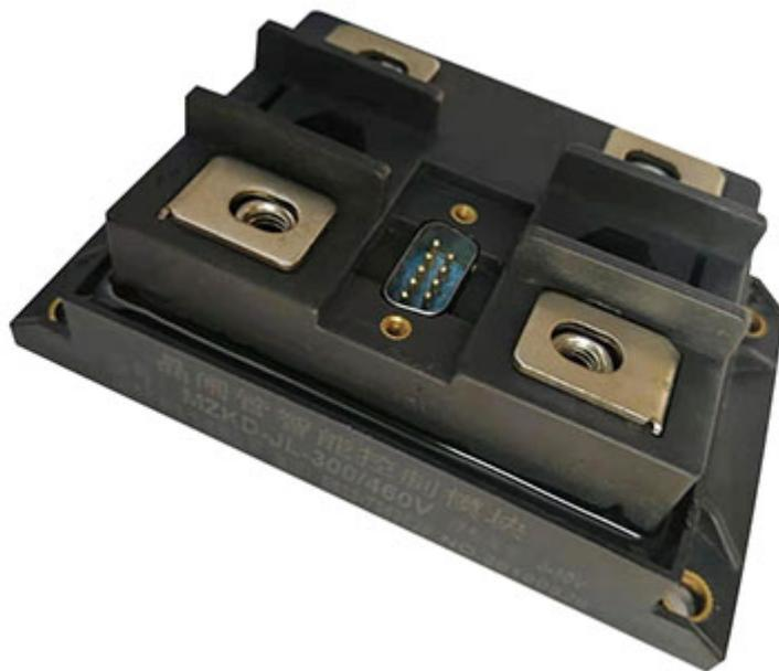
可控硅模块通常被称之为功率半导体模块（semiconductor module）。可控硅模块从内部封装芯片上可以分为可控模块和整流模块两大类；从具体的用途上区分，可以分为：普通晶闸管模块（MTCMTXMTKMTA）、普通整流管模块（MDC）、普通晶闸管、整流管混合模块（MFC）、快速晶闸管、整流管及混合模块（MKCMZC）、非绝缘型晶闸管、整流管及混合模块（也就是通常所说的电焊机所用模块MTGMDG）、三相整流桥输出可控硅模块（MDS）、单相（三相）整流桥模块（MDQ）、单相半控桥（三相全控桥）模块（MTS）以及肖特基模块等。下面是一个坏了换下来的电阻焊控制器一
